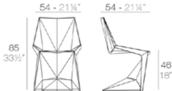
Fabricado en polipropileno por inyección y reforzado con fibra de vidrio. Apilable. Disponible en varios colores. Apto para uso interior y exterior.
