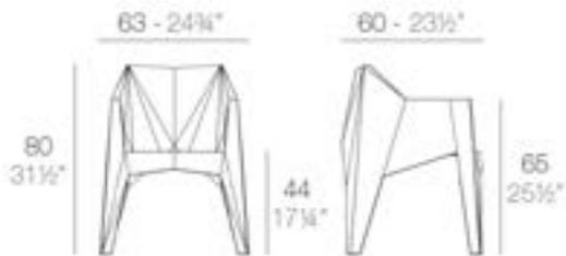
Fabricado en polipropileno por inyección y reforzado con fibra de vidrio. Apilable. Disponible en varios colores. Apto para uso interior y exterior.
