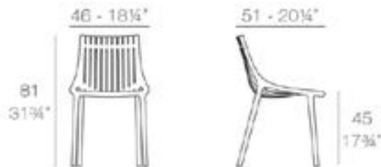
Fabricado en polipropileno por inyección con gas y reforzado con fibra de vidrio. Apilable. Disponible en varios colores. Apto para uso interior y exterior.
