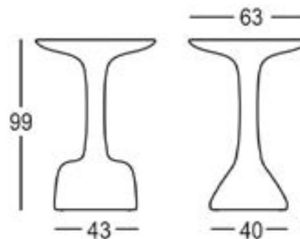
Mesa de base central de polietileno fabricada con la técnica de rotomoldeo.
