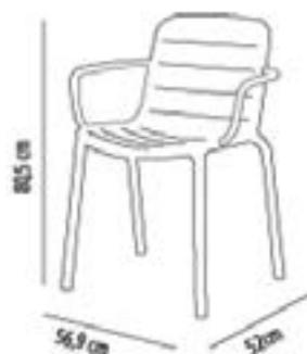
Silla con brazos para uso interior y exterior. Inyectada en fibra de vidrio con PP mediante tecnología de moldeo asistida por gas. Apilable. Protección UV. Peso neto 3,65 kg. Tornillos inoxidables.
