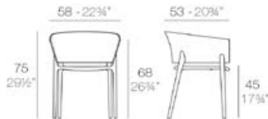
Fabricado en polipropileno por inyección con gas y reforzado con fibra de vidrio. Apilable. Disponible en varios colores. Apto para uso interior y exterior.
