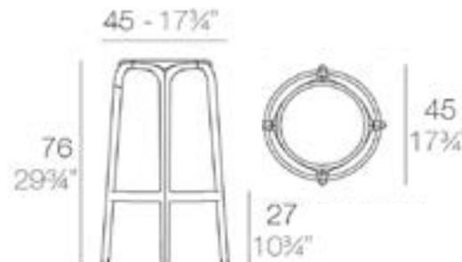
Fabricado en polipropileno por inyección y reforzado con fibra de vidrio. Apilable. Disponible en varios colores. Apto para uso interior y exterior.
