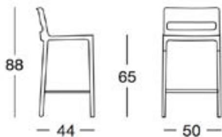
Taburete con estructura en aluminio anodizado con sección cuadrada de mm. 25x25. Asiento en tecnopolímero. Apilable.
