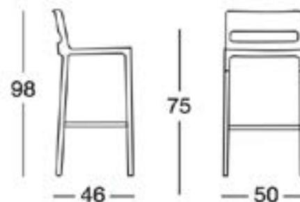
Taburete con estructura en aluminio anodizado con sección cuadrada de mm. 25x25. Asiento en tecnopolímero. Apilable.
