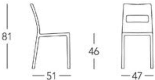
Estructura en tecnopolímero reforzado con fibra de vidrio. Moldeada por inyección con técnica air moulding. Disponible en diferentes colores. Apilable. Para uso interno/externo. Conforme CATAS EN 16139:2013 nivel L2 - extremo.
