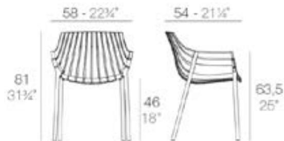
Fabricado en polipropileno por inyección y reforzado con fibra de vidrio. Apilable. Disponible en varios colores. Apto para uso interior y exterior.
