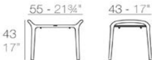
Sillón para uso interior y exterior. Inyectado con fibra de vidrio y PP. Protección UV. Fabricado en polipropileno por inyección con gas y reforzado con fibra de vidrio. Apilable. Disponible en varios colores. Apto para uso interior y exterior.
