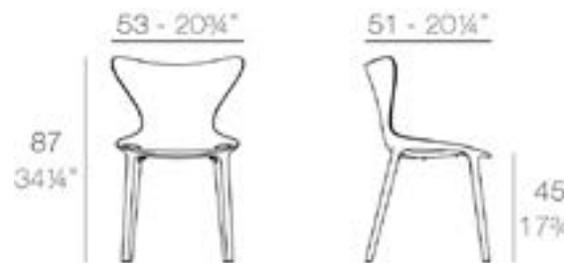
Fabricado en polipropileno por inyección con gas y reforzado con fibra de vidrio. Apilable. Disponible en varios colores. Apto para uso interior y exterior.
