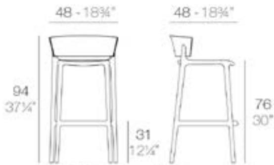
Fabricado en polipropileno por inyección con gas air moulding y reforzado con fibra de vidrio. Apilable. Disponible en varios colores. Apto para uso interior y exterior. Peso: 5.14 Kg
