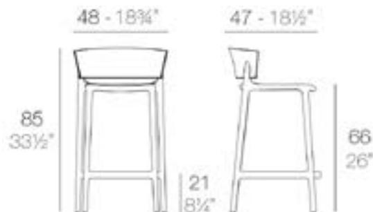
Fabricado en polipropileno por inyección con gas air moulding y reforzado con fibra de vidrio. Apilable. Disponible en varios colores. Apto para uso interior y exterior. Peso: 4.76 Kg
